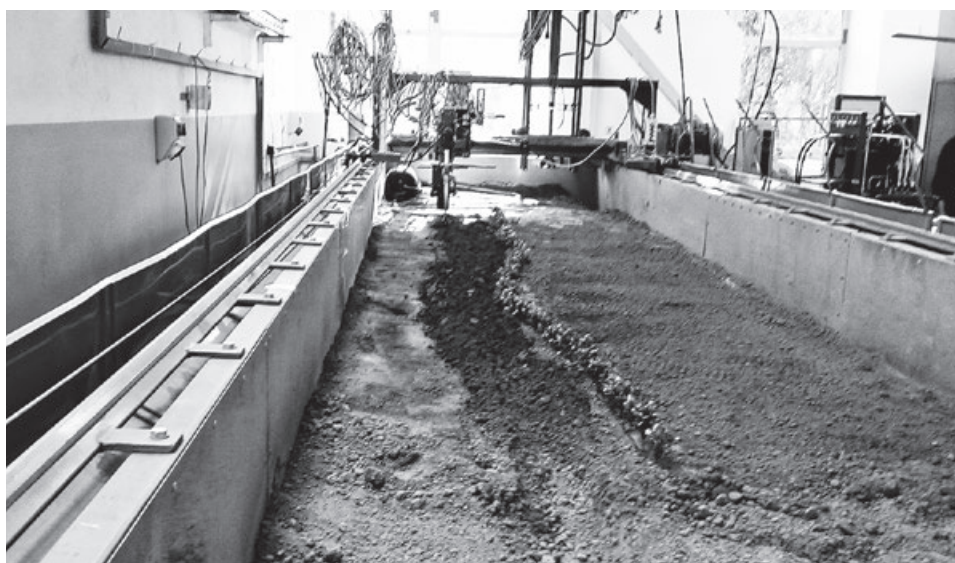
Efekt pracy pielnika z mechanizmem nadążnym sterowanym przez kamerę śledzącą krzywoliniowość rzędu
